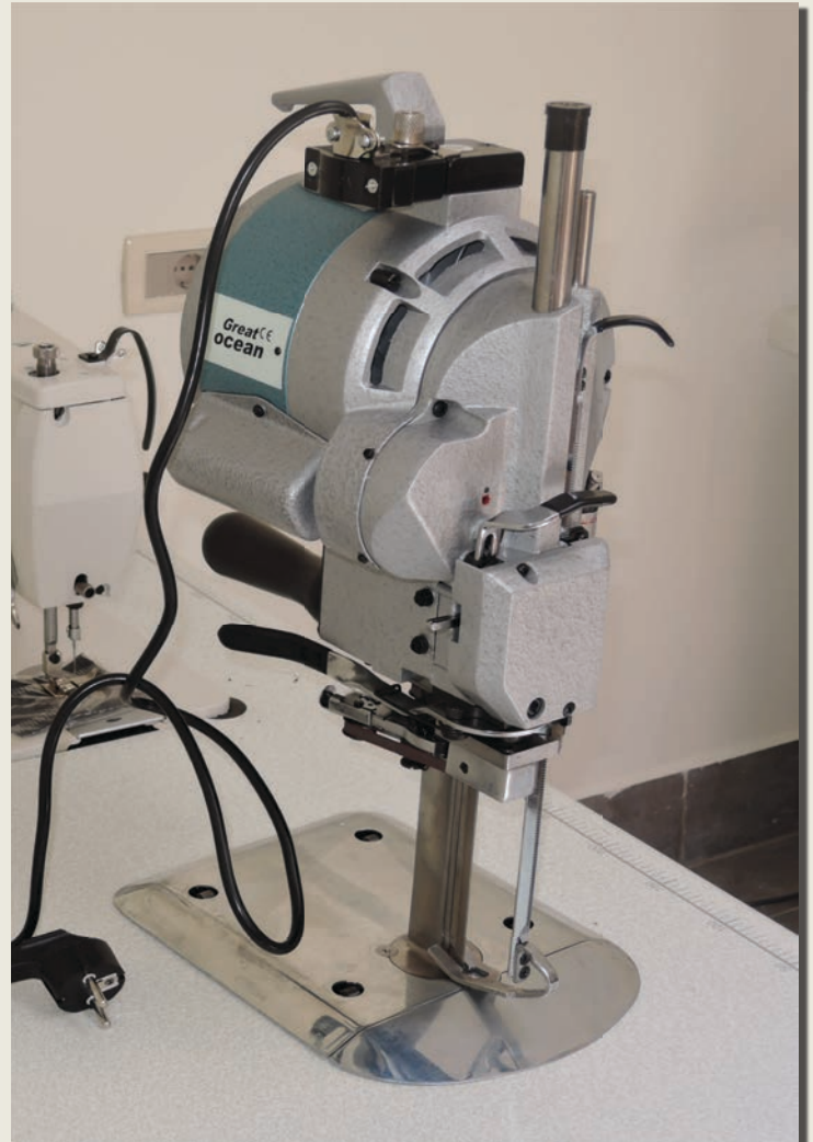
Dos vistas de la cortadora industrial vertical de tela de 6 pulgadas con sistema automático de lubricación y motor de 220 voltios y 550 vatios
